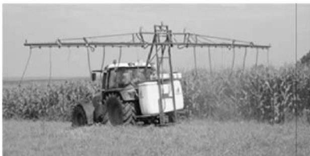
Slika 2: Škropilnica z visoko nameščenimi škropilnimi letvami in cevni podaljški do koruznega storža, ki se uporablja za zatiranje odraslih osebkov koruznega hrošča (foto: Š. Modic).
