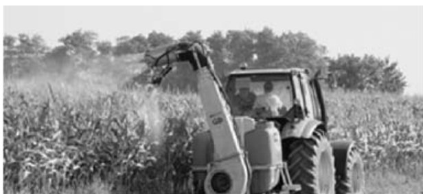
Slika 3: Pršilnik s pršilnim topom za nanašanje insekticidov proti odraslemu koruznemu hrošču (foto: Š. Modic).
